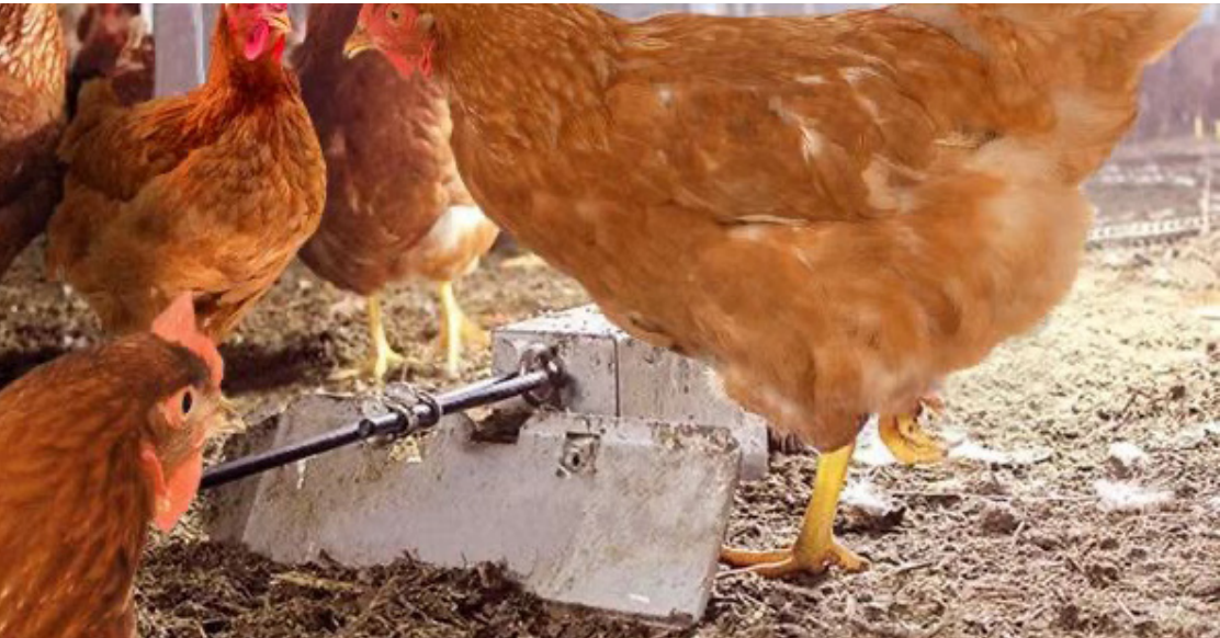
Pengikis dipasang di bawah sistem bebas sangkar untuk membantu mengikis dan mengawal ketebalan alas dan mengawal paras ammonia. Tiada hakcipta.
